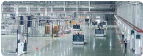
Bên trong phân xưởng sản xuất tự động hóa hiện đại với hệ thống xe tự hành AGV
